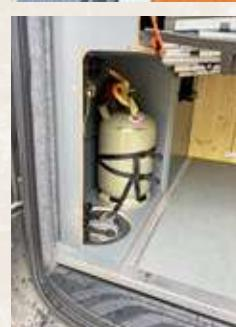
Zwei Wassertanks, zwei Gasflaschen: Flowcamper setzt auf Redundanz und hohe Ausfallsicherheit. Aufwendige Isolierung, keine nackten Metallflächen zu sehen.
